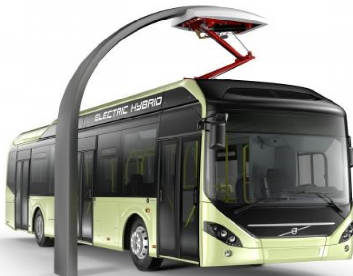
Rysunek 2. Pantografowa stacja ładowania autobusów hybrydowych
